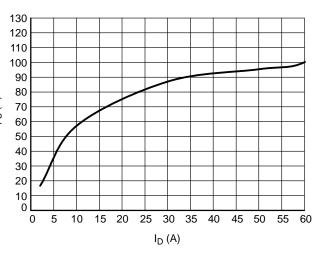
Figure 12. G<sub>FS</sub> vs. I<sub>D</sub>
