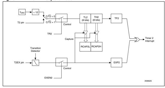
Figure 25. Timer 2 in Auto-Reload mode
