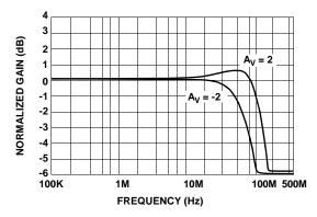
FIGURE 36. VIDEO LINE DRIVER FREQUENCY RESPONSE
