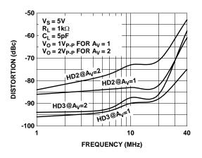
FIGURE 19. HARMONIC DISTORTION vs FREQUENCY
