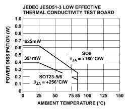
FIGURE 29. PACKAGE POWER DISSIPATION vs AMBIENT TEMPERATURE
