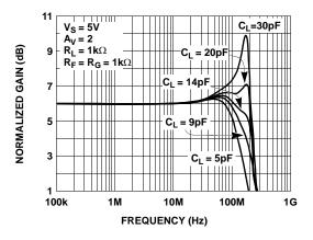
FIGURE 8. SMALL SIGNAL FREQUENCY RESPONSE FOR VARIOUS  $\mathbf{C_L}$
