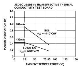
FIGURE 28. PACKAGE POWER DISSIPATION VS AMBIENT TEMPERATURE
