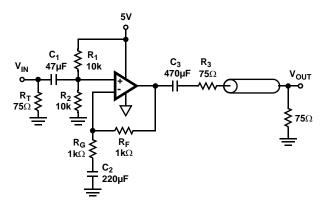
FIGURE 34. 5V SINGLE SUPPLY NON INVERTING VIDEO LINE DRIVER
