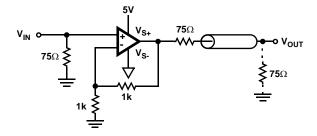
FIGURE 30. SYNC PULSE REMOVER
