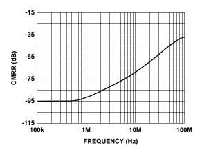
FIGURE 15. COMMON-MODE REJECTION RATIO vs FREQUENCY
