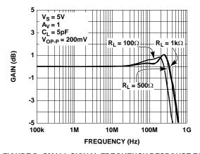
FIGURE 5. SMALL SIGNAL FREQUENCY RESPONSE FOR VARIOUS  $\rm R_{LOAD}$
