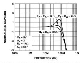
FIGURE 2. SMALL SIGNAL FREQUENCY RESPONSE  ${\rm vs} \; {\rm R_F} \; {\rm AND} \; {\rm R_G}$
