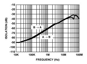
FIGURE 13. CHANNEL ISOLATION vs FREQUENCY
