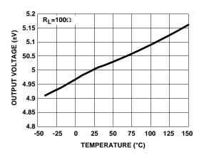
FIGURE 21. OUTPUT VOLTAGE vs TEMPERATURE
