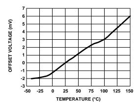
FIGURE 24. OFFSET VOLTAGE vs TEMPERATURE
