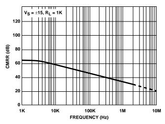
FIGURE 14. COMMON MODE REJECTION RATIO vs FREQUENCY
